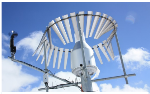
Figur 5.3: Vindsensormontasje på Geonorstolpe, her Sør-Geonor
