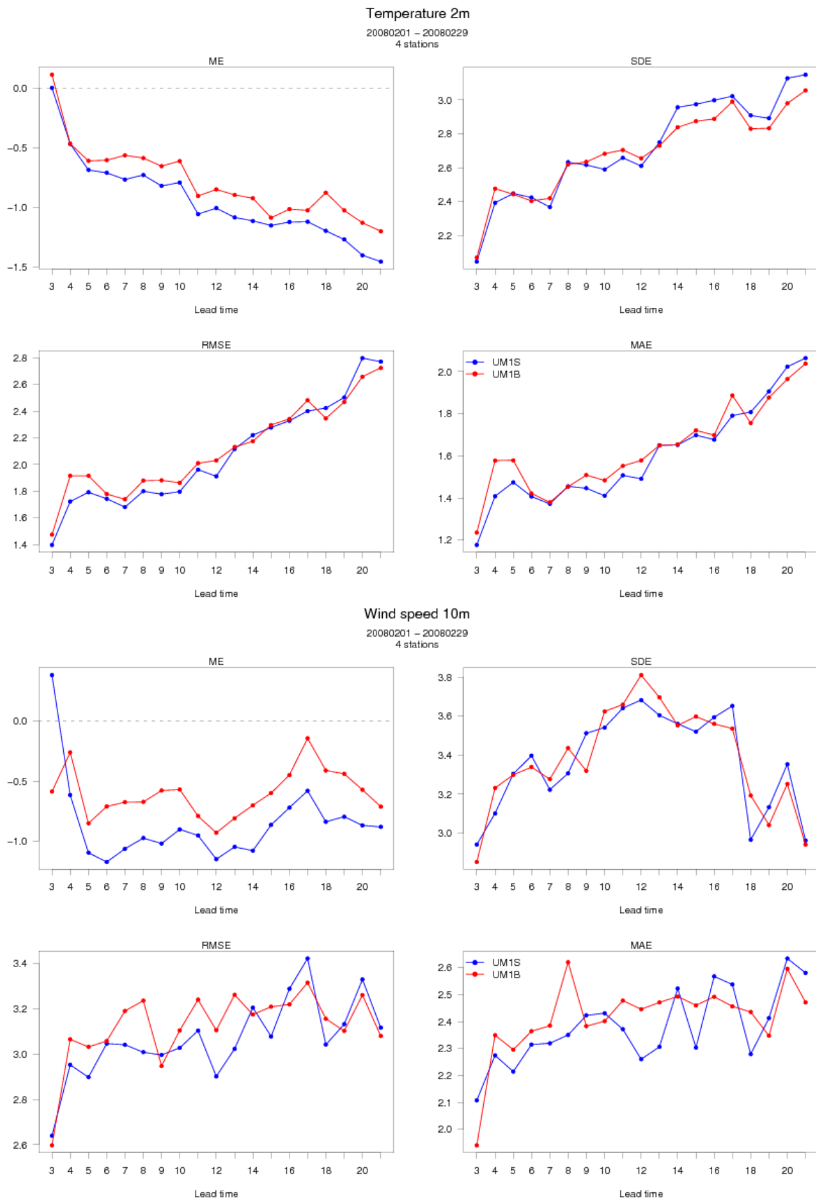
Figur B2.7 Feilstatistikk for T2m (øverst) og FF10m (nederst) og UM1NN og UM1 for Hammerfest/Honningsvåg og Narvik for februar 2008. Øverst til venstre bias, øverst til høyre standardavvik av feilen, nederst til venstre root mean square error og nederst til høyre gjennomsnittlig absolutt feil.
