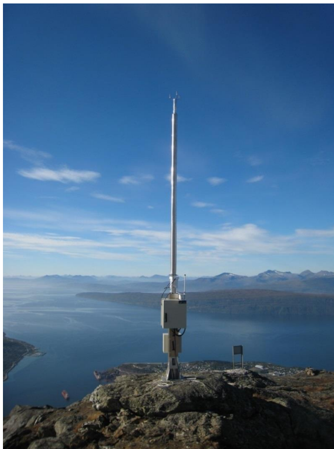
Figur 5. Vindstasjonen Narvik - Fagernesfjellet med 6 m oppvarmet mast.
