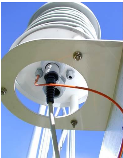
Pt 100 1/10 DIN element støpt inn i plexiglassrør montert inn i MET strålingshytte.
