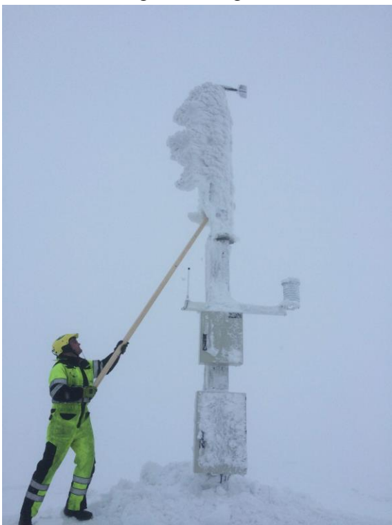
Figur 10. Røldalsfjellet - Elvershei med 5 m mast uten varme. Tilsynsman fjerner is.
