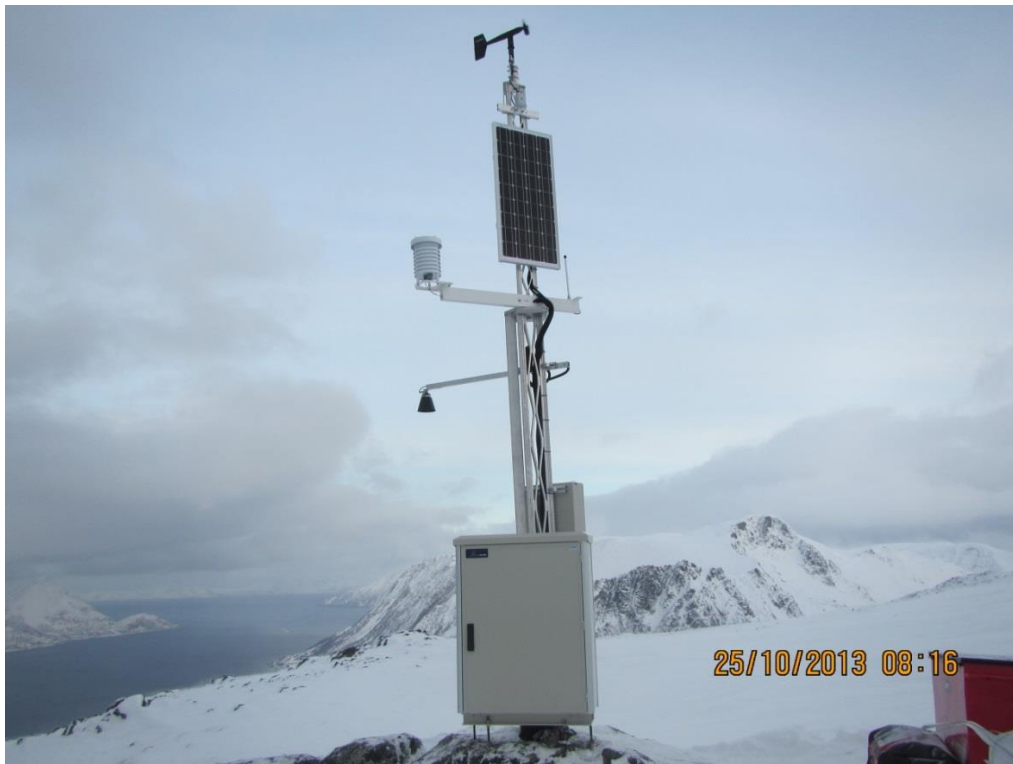
Figur 6. Vindstasjonen Øksfjord - Deallja med 5 m mast og stort batteriskap.
