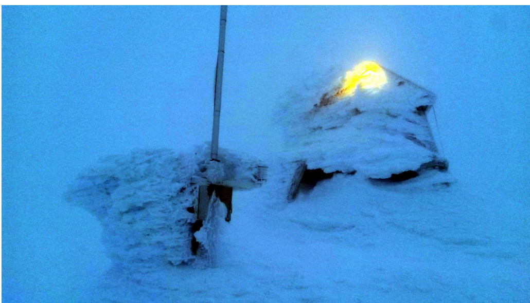
Figur 11. Stasjonen Kistefjell der alt over 2 m er oppvarmet og isfritt.
