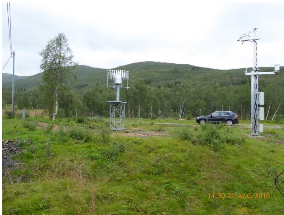
Figur 2. Eksempel på en standard 220V nedbørstasjon i Kanstadbotn.
