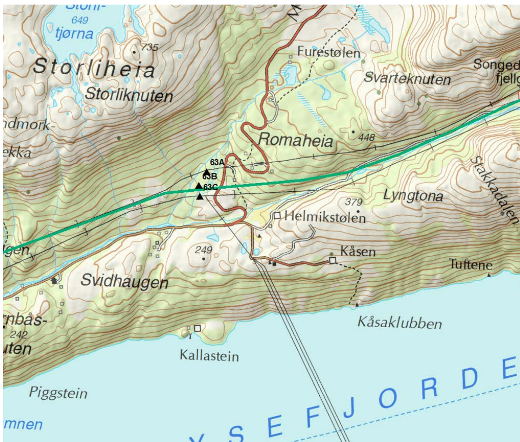
Figur 3: Mastepunktene for 132 kV kraftledning ved Helmikstølen vist som svarte triangler. Trase for 420 kV kraftledning i grønt (Kartdata er fra Kartverket)
