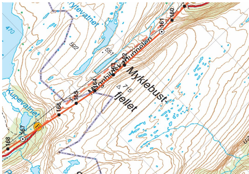
Figur 2 Oversikt over ledningstrasé ved kommunegrensene mellom Flora og Bremanger vest for Myklebustfjellet. Mast 164 ligger på ca 650 moh. I kartet vises 1 km ruter og høydekoter med ekvidistanse 20 m. Kartet er orientert 45 grader (med klokken) i forhold til nord.
