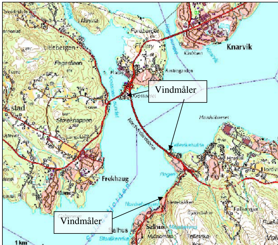
Figur A.10 Nordhordlandsbrua med målesteder
