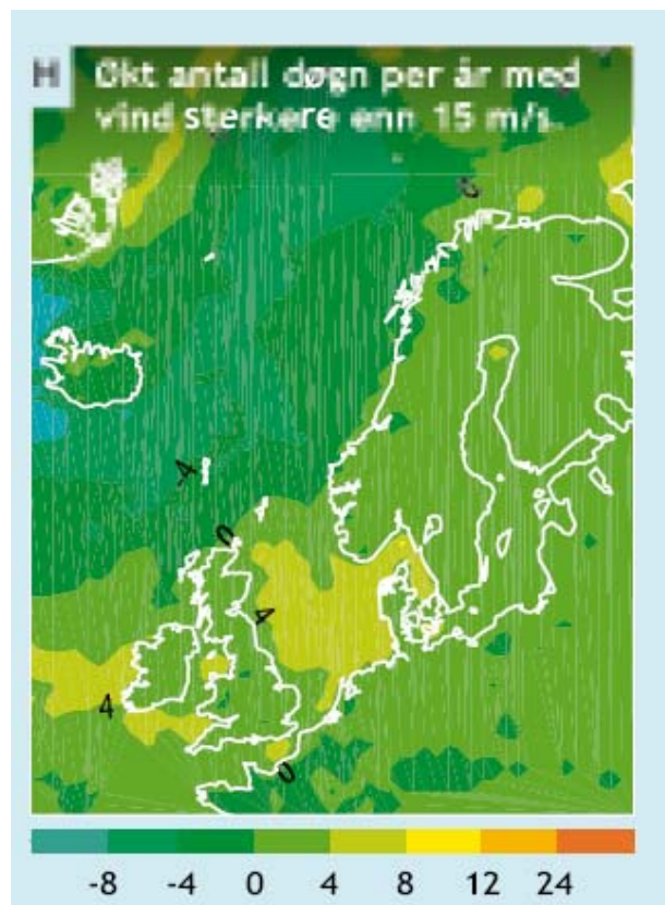
Figur 8 Forventet økning i antall døgn per år med vind sterkere enn 15 m/s. Fra Regclim [16].
